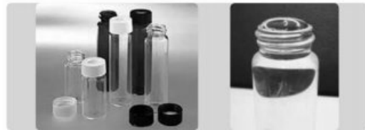
รูปที่ 19 ตัวอย่างขวดเก็บตัวอย่างน้ำเพื่อวิเคราะห์สารอินทรีย์ระเหยและลักษณะน้ำขุ่นบนปากขวด
